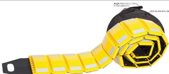
A Lombada Portátil Elo é um equipamento desenvolvido para facilitar o controle da velocidade em locais onde o trânsito possui horários irregulares de fluxo intenso. De fácil instalação, é necessário apenas um agente para sua manipulação. Resistente, suporta veículos de até 45 toneladas.
