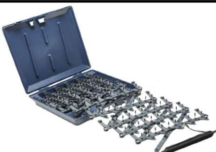
O Bloqueador de Fuga Elo é um dispositivo de esvazramento de pneus usado para parar veículos em alta velocidade em perseguições ou fiscalizações de trâfego. Cada sistema é constituído por agulhas oca de aço inoxidável montado numa resistente e reutilizável base pantográfica. O sistema possui um cordão de nylon 10 metros, para o manuseio da grade principal. O Bloqueador vem acondicionado em uma maleta compacta rígida para seu transporte. O kit tem 30 agulhas extras e um trocador de agulhas.
