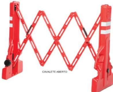
Cavalete retrátil, portátil, fabricado em polietileno de alta resistência, com inibidor UV-A e B, formado por 2 bases oca. Dotado de tampa rosqueável para regulagem de peso por água ou areia e unidas por sistema pantográfico composto por 6 réguas plásticas. Possui travas de segurança para maior estabilidade do produto e alça para transporte. A flexibilidade do cavalete feita por 4 tiras retrorefletivas de micro prisma branco.
